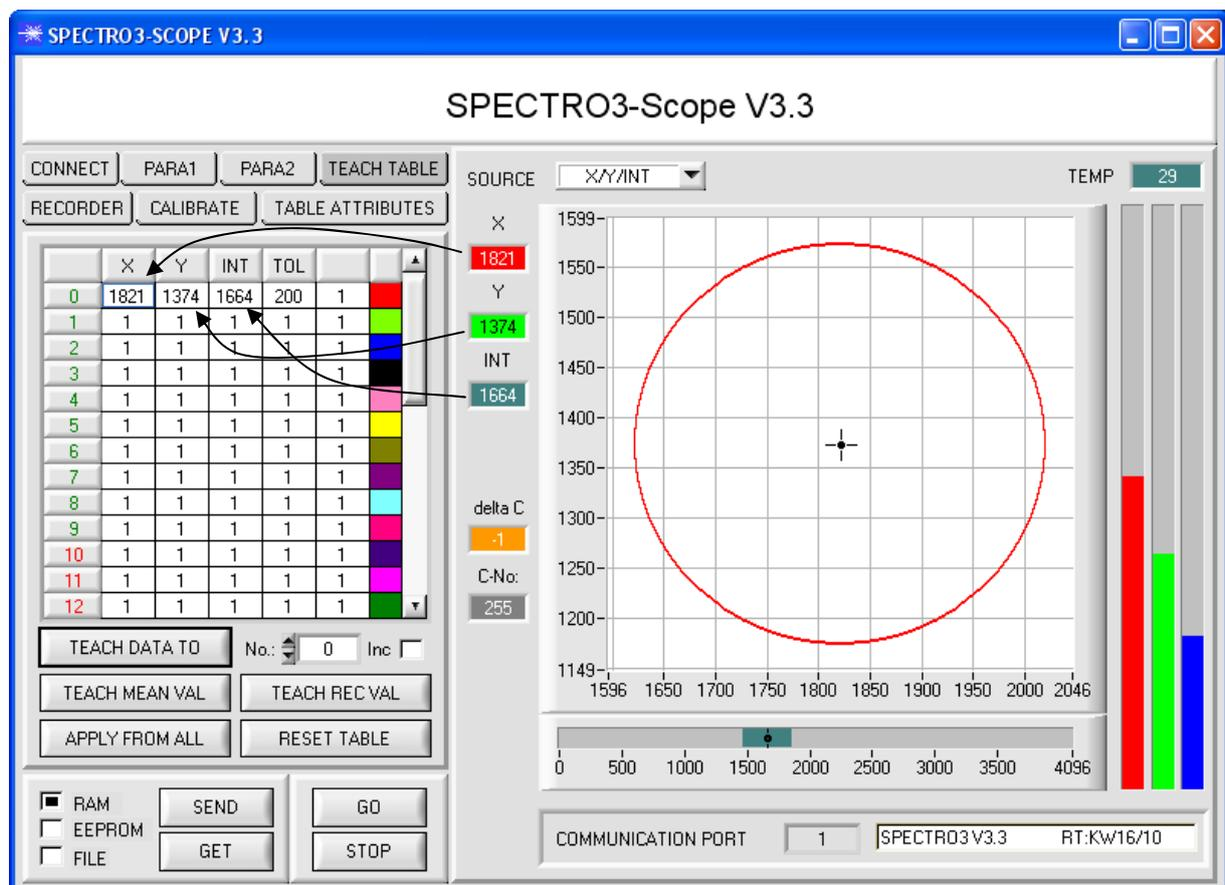
Drücken Sie nun wieder die Taste **SEND**, um dem Sensor die gelernte Farbe mitzuteilen. Aktivieren Sie den **GO** Modus wieder. Wenn der Sensor einen Zeilenvektor wieder erkennt (Farbe), wird die entsprechende Zeilennummer unter **C-No.:** auf der Software-Oberfläche visualisiert. Der Wert 255 bedeutet, dass keine der gelernten Farben wieder erkannt wurde.
